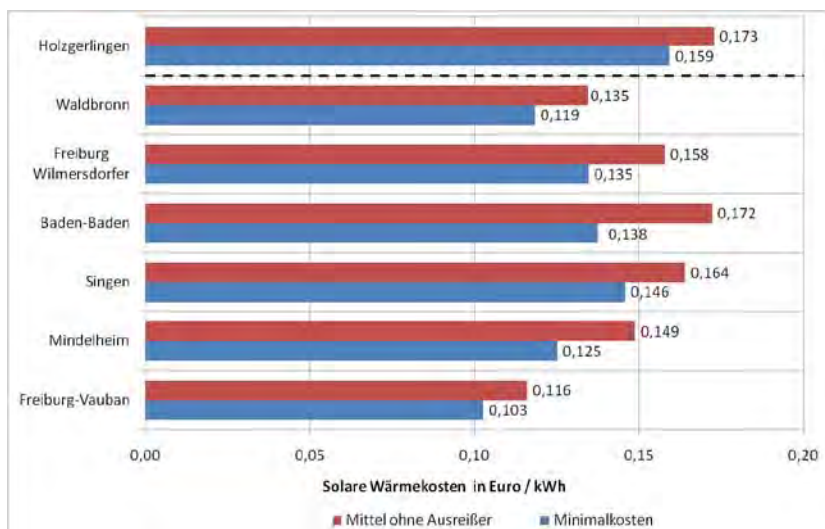
Abb. 9: Die solaren Nutzwärmekosten geben den Preis pro kWh Nutzwärme an. Sie werden berechnet aus dem Quotienten der Systemkosten (Investitionskosten für die Planung und Errichtung des Solarsystems und die Kapitalkosten bei 6 % Zins und einer Anlagenlebensdauer von 20 Jahren) und dem Jahresertrag des Solarsystems.
